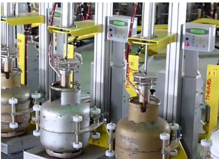
Σχ. 5/16 Τα πνευματικά συστήματα χρησιμοποιούνται στην εμφιάλωση υγραερίου.
