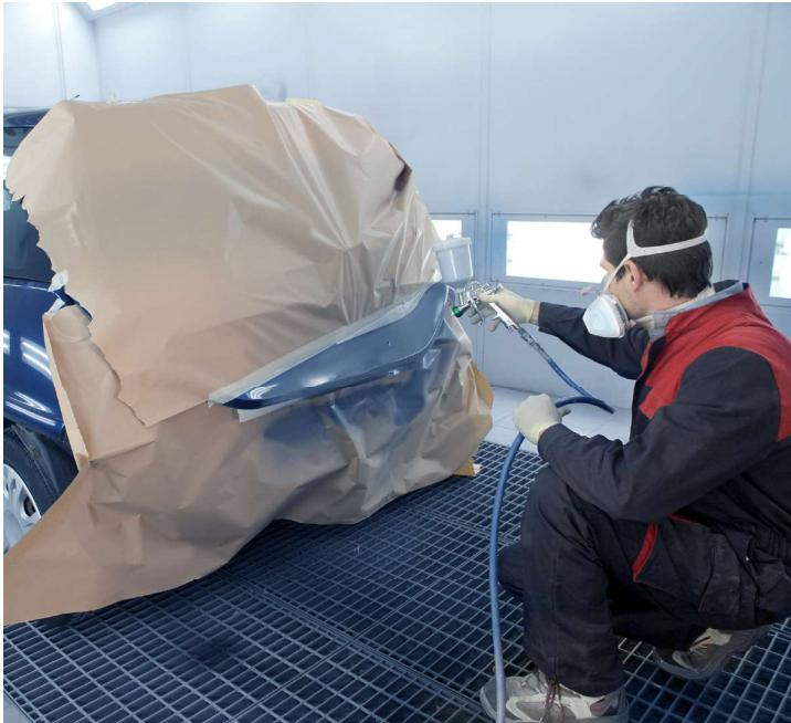
Σχ. 5/15 Χρήση πιεσμένου αέρα για τη βαφή αυτοκινήτων
