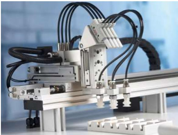
Σχ. 5/11 Πνευματικά συστήματα χρησιμοποιούνται για τη συσκευασία φαρμάκων
